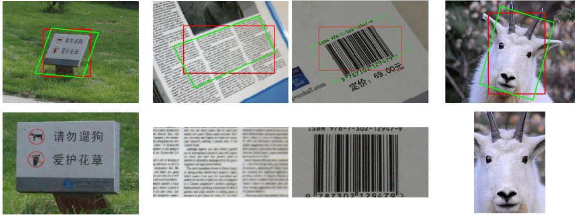
图 4 利用 TILT 模型进行图像校正的例子。第一行表示原始的图像块（长方形框）及相应校正变换（四边形框，校正变换就是四边形框相对于长方形框的几何变换），第二行是校正后的图像块。
